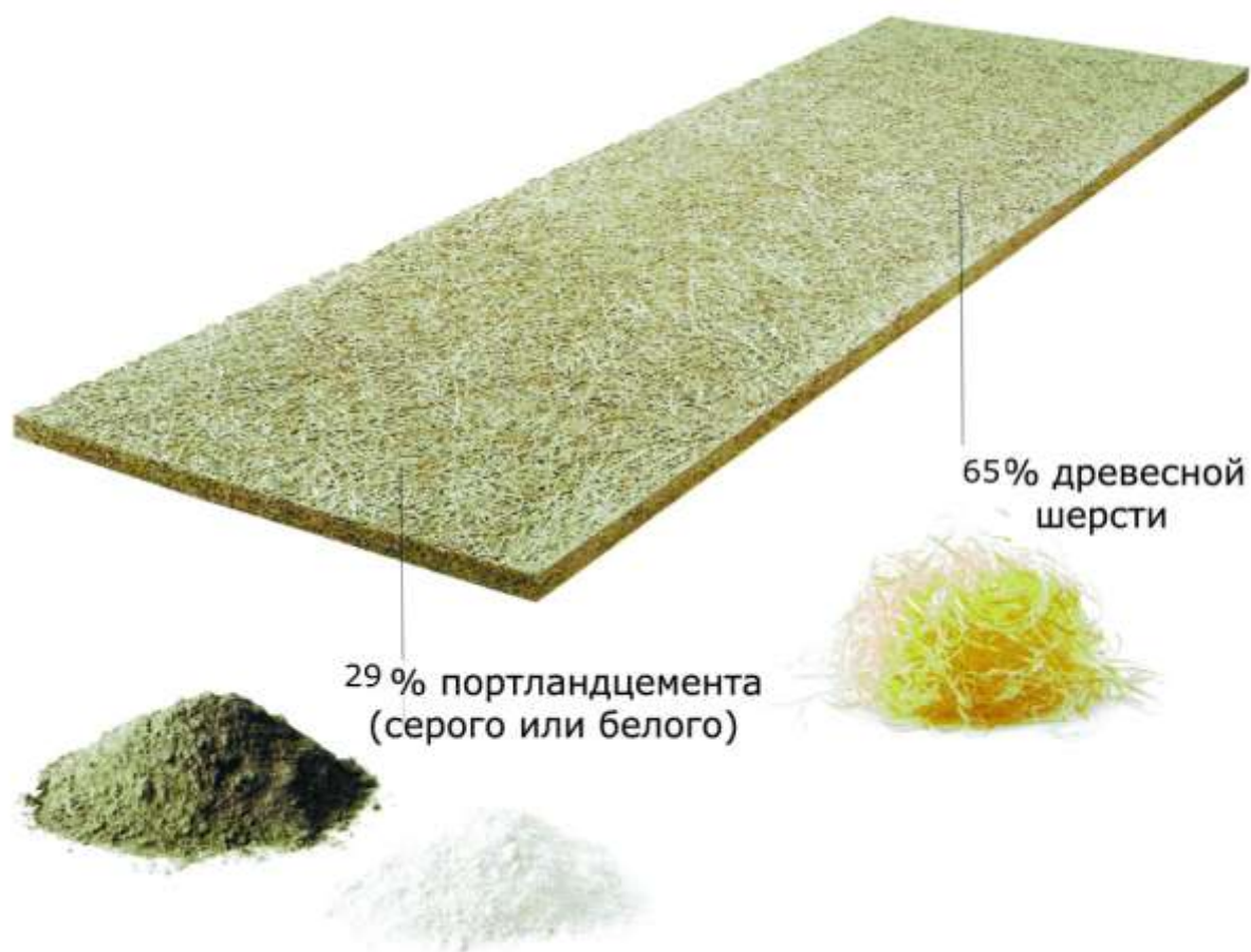
Рис. Состав плит Green Board®
