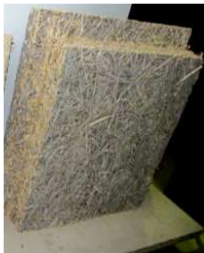
Рис.11.6 Образец фрезерованной плиты GB1 для соединения способом «в четверть»
