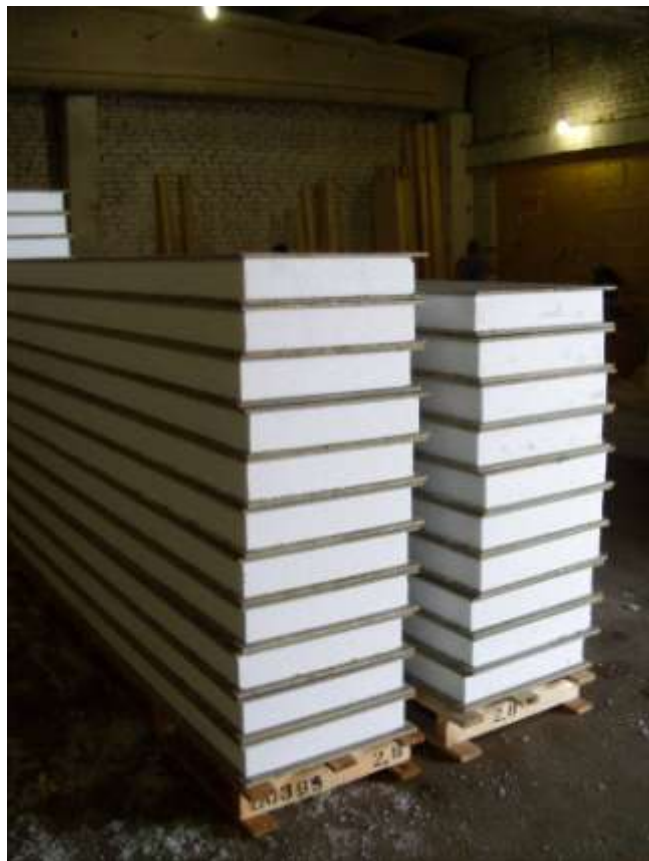
Рис. 9.7 SIP панель с применением плиты GB3
