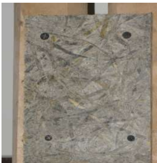
Рис.11.9 Пример крепления плиты GB-3 с использованием саморезов
