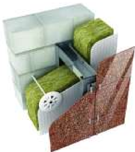
Рис. 11.14 Стеновая конструкция с применением дюбель-гвоздя
