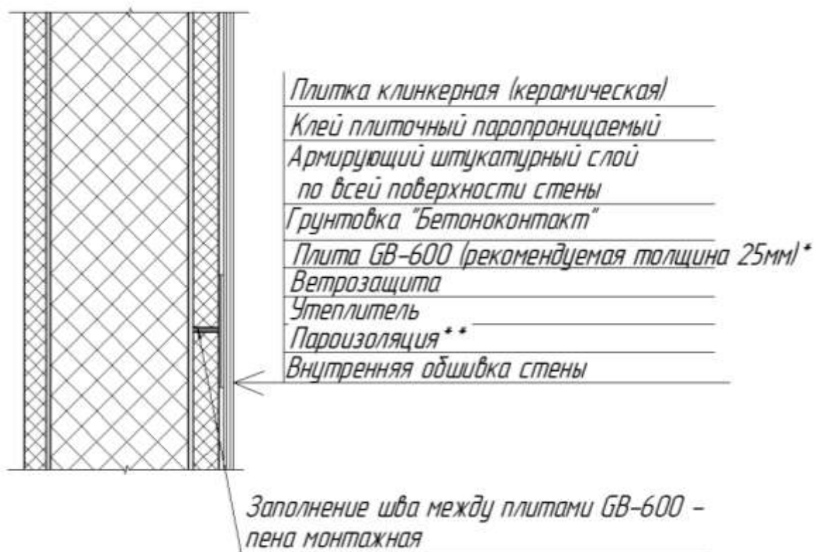
Рис.2.14 Разрез стены. Вид сбоку.
