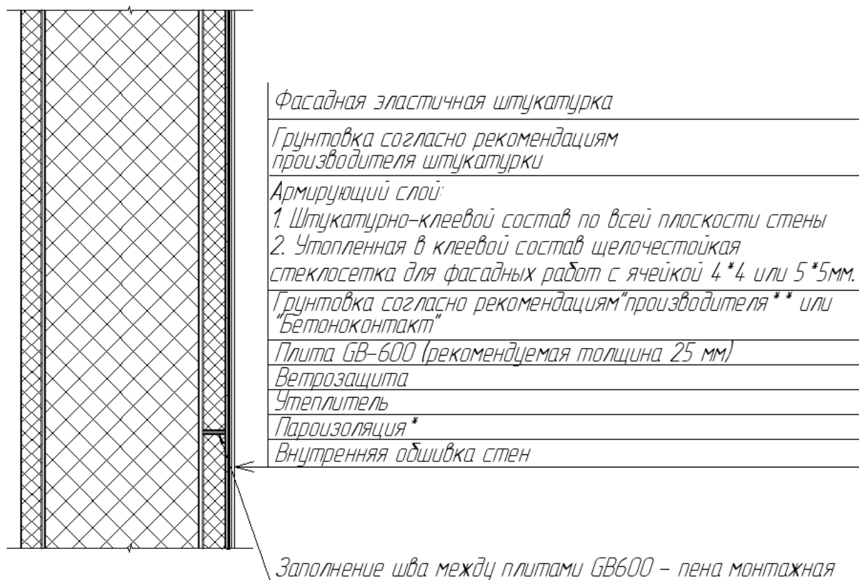
Рис.2.13 Разрез стены. Вид сбоку
