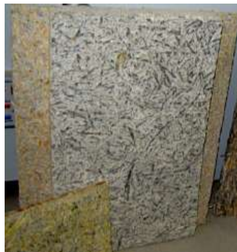
Рис.11.7 Образец фрезерованной плиты GB3 для соединения способом «в четверть»
